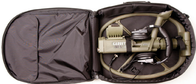
Figura 4: ATX con bobina Deepseeker acoplada + auriculares. Fije las correas alrededor de la tuerca de la varilla inferior y de la caja.
